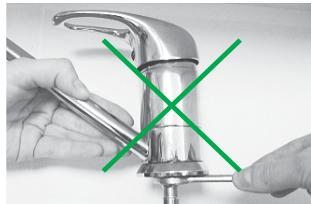
5. Подключение смесителя следует производить со снятым (открученным) аэратором во избежание засорения аэратора при пуске воды.
