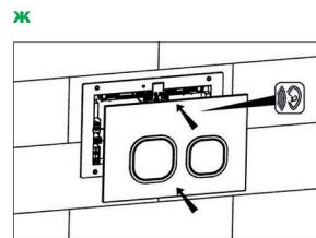
Для демонтажа клавиши нажмите на кнопку в торце изделия сверху / Перенеі демонтажды үшін өнімнің жағындағы түймені басыңыз.
